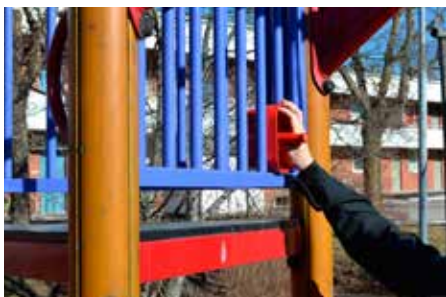
Kalibrerad mätsond mäter spjälmellanrum, får vara max 8,9 cm.
