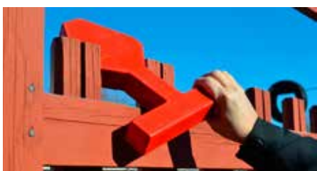
Kalibrerad mätsond mäter spjälmellanrum, 23 cm för axlar och 4,5 cm för hals.
