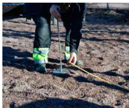
Fallsand mäts vid olika kontrollpunkter.
